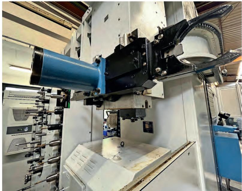
Der Produktivitätsbringer: Mit dem neu installierten Werkzeugwechsler und dem 60er-Werkzeugmagazin ist die TC110 nun auch im zwei- und dreischichtigen Betrieb einsetzbar.
