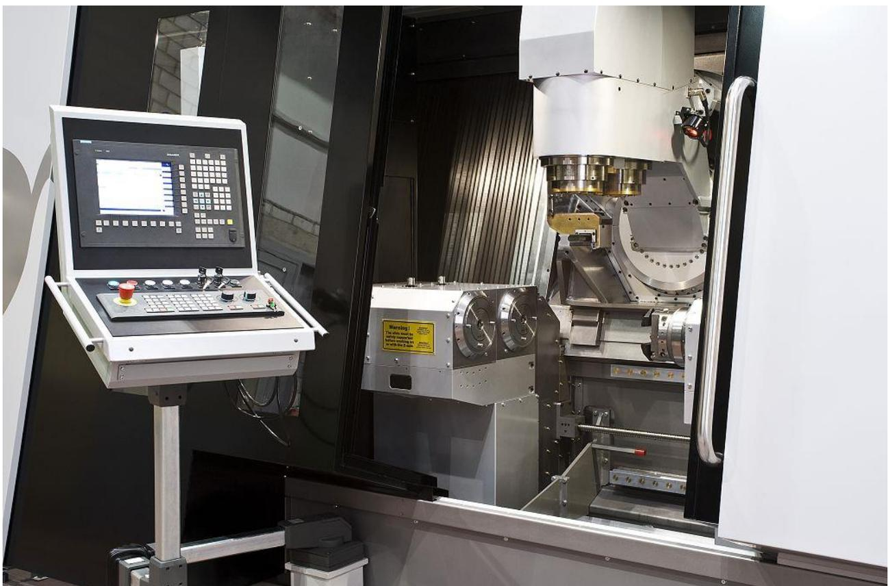
Die LIECHTI Turbomill 800g ist eine hochdynamische fünfachsiges Fräsmaschine mit höchsten Achsbeschleunigungen, konzipiert für das Hochgeschwindigkeitsfräsen in 5 Achsen.
