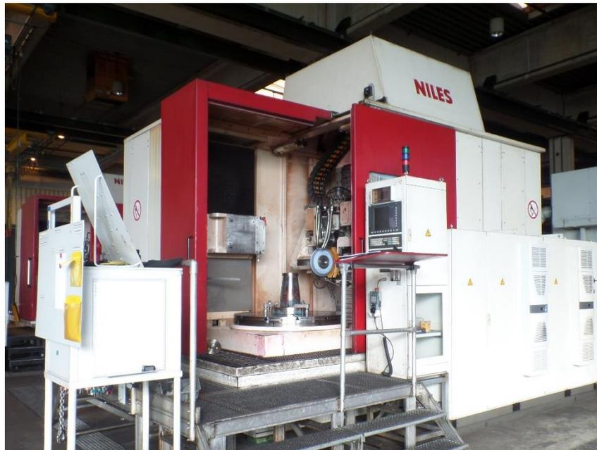
CNC-Profileschleifmaschine zum Schleifen von geraden und schrägen **Aussen- und Innenverzahnungen** an zylindrischen Werkstücken sowie allen schleifbaren Profilen und Formen im **Einzelteilverfahren**.
